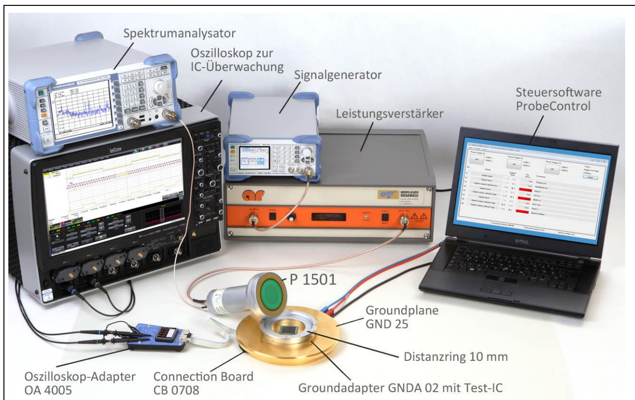
Bild 57 Prüfaufbau mit dem Probe Set HF-Power Feldeinkopplung 1 GHz, der IC-Testumgebung ICE1 und weiteren Geräten.(vereinfachter Aufbau ohne Richtkoppler)
